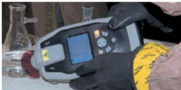
Fig 6: Espectroscopia Raman portátil.
