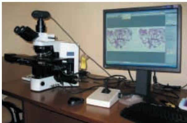
Fig. 1: Sistema de microscopía virtual Olympus-SIS .slide.
