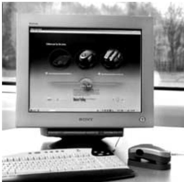
*Fig. 1: Monitor Sony Trinitron F20. Los monitores CRT son aún imprescindibles para evaluar detalladamente imágenes digitales (5).*
