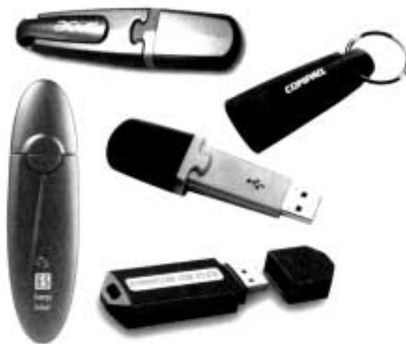
Fig. 6: Diversos modelos de unidades de almacenamiento USB (USB.stick).
