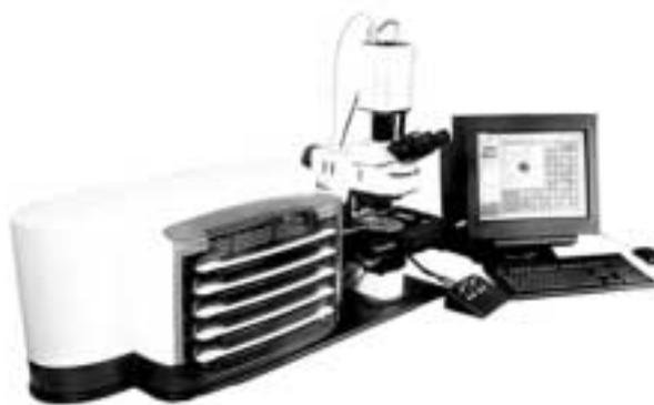
Fig. 7: Ariol SL-50 es un completo sistema de digitalización de preparaciones y análisis de imagen, con numerosos módulos para inmunohistoquímica y matrices de tejidos.
